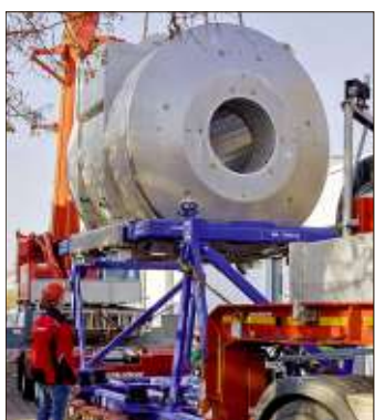
Der riesige Magnet ist das Kernelement des 7-Tesla-MRT auf dem Magdeburger Unicampus. Foto: Anna Friese/Uni Magdeburg
